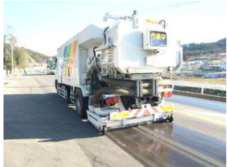
排水性舗装機能回復車 (高圧洗浄)
