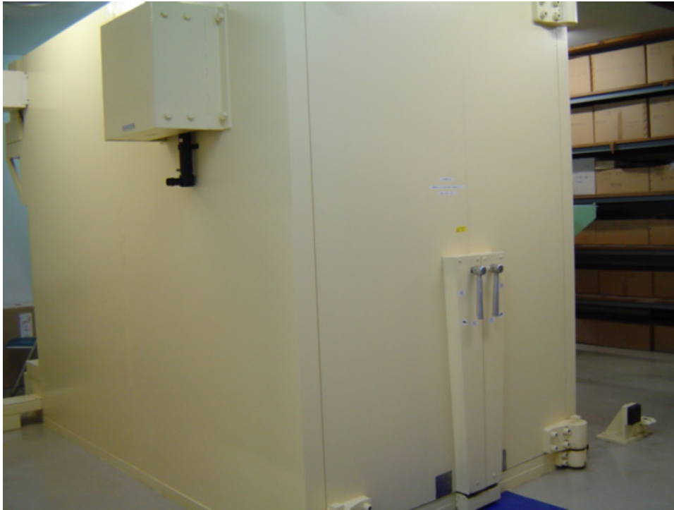
鉄室 壁厚鉄20cm、鉛3mm、プラスチック5mm
