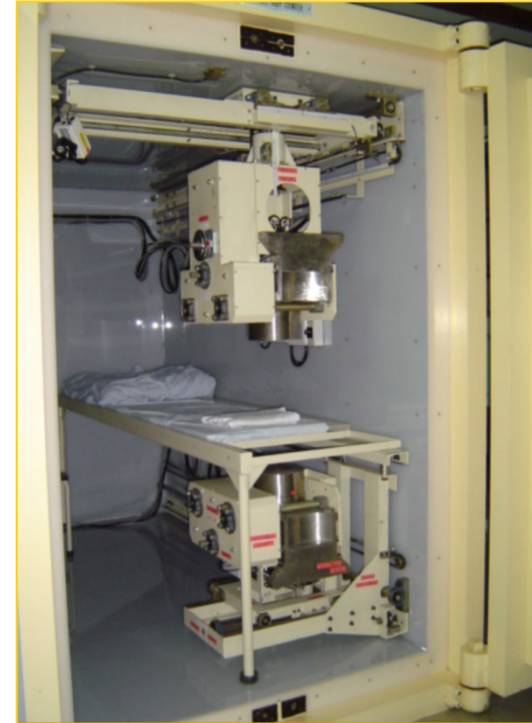
NaI(Tl)シンレーション検出器 直径8インチ×厚さ4インチ、上下一対 光電子増倍管 直径3インチ×8本
