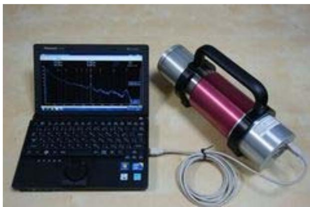
図 4d. NaI(Tl) 検出器を PC に接続できる装置(パソコンマルチ)
