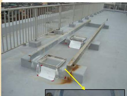
放医研の屋上にステンレス製のバットを水平に2つ設置
